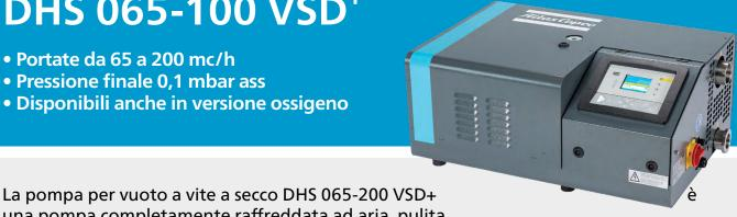
una pompa completamente raffreddata ad aria, pulita, compatta e intelligente dotata di tecnologia con azionamento a velocità variabile e caratterizzata da un design robusto e di dimensioni ridotte, il che la rende ideale per le applicazioni industriali anche gravose. Offre portate da 65 m<sup>3</sup>/h fino a 100 m<sup>3</sup>/h per una pressione finale di 1 mbar (a).
